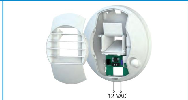
Le bocchette ALIZÉ TEMPO assicurano una portata permanente di 5 m<sup>3</sup>/h e una portata complementare di 30 m<sup>3</sup>/h temporizzata (30 minuti) attivabile dall'utente.
