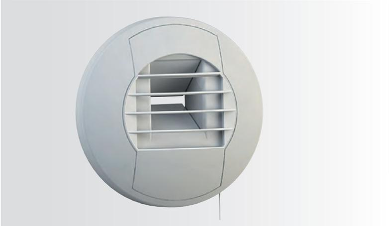
Le bocchette ALIZÉ TEMPO assicurano una portata permanente di 5 m<sup>3</sup>/h e una portata complementare di 30 m<sup>3</sup>/h temporizzata (30 minuti) attivabile dall'utente.
