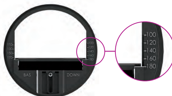
Esempio di regolazione a 180 m 3 /h. Regolatore posizionato sulla scala a destra
