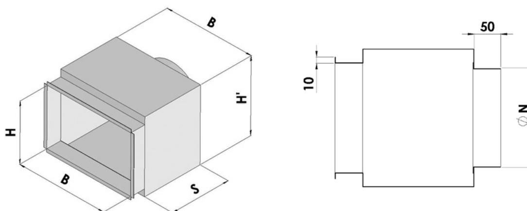
PS2M-Plenum standard realizzato in acciaio zincato sendzimir con attacco posteriore.
