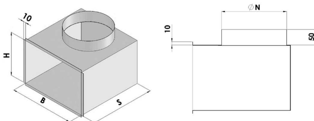
PS1-Plenum standard realizzato in acciaio zincato sendzimir con attacco laterale.
