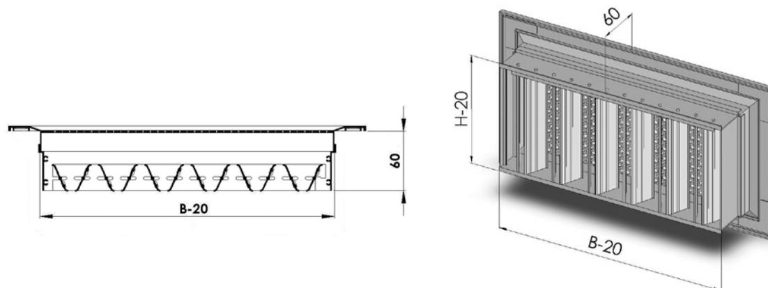
BSF con serranda a movimento contrapposto e con alette parallele al lato corto, costruita interamente in alluminio, azionabile tramite cacciavite dalla parte frontale della griglia, a richiesta è possibile applicare un servomotore sia proporzionale che on/off.
