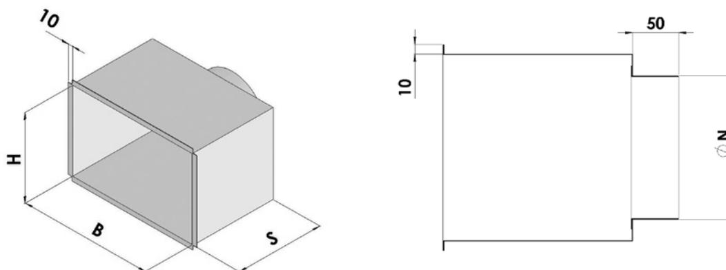
PS2-Plenum standard realizzato in acciaio zincato sendzimir con attacco posteriore.
